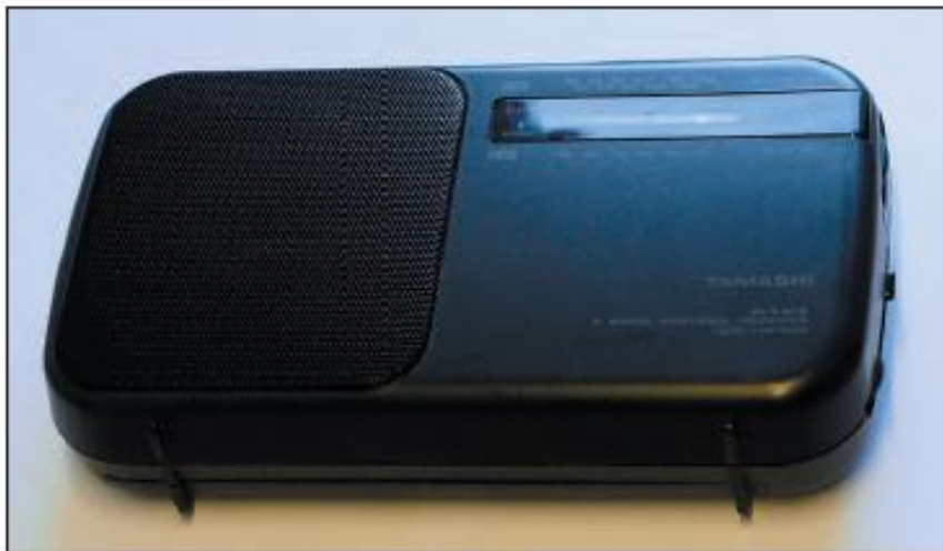
Bild 8. Dieses einfache Kofferradio mit LW-Bereich habe ich mir für einen lächerlichen Betrag bei eBay „geschossen“. Es dient als universeller Empfänger zum Aufspüren von Unterbrechungen bei versteckten Leitungen.
